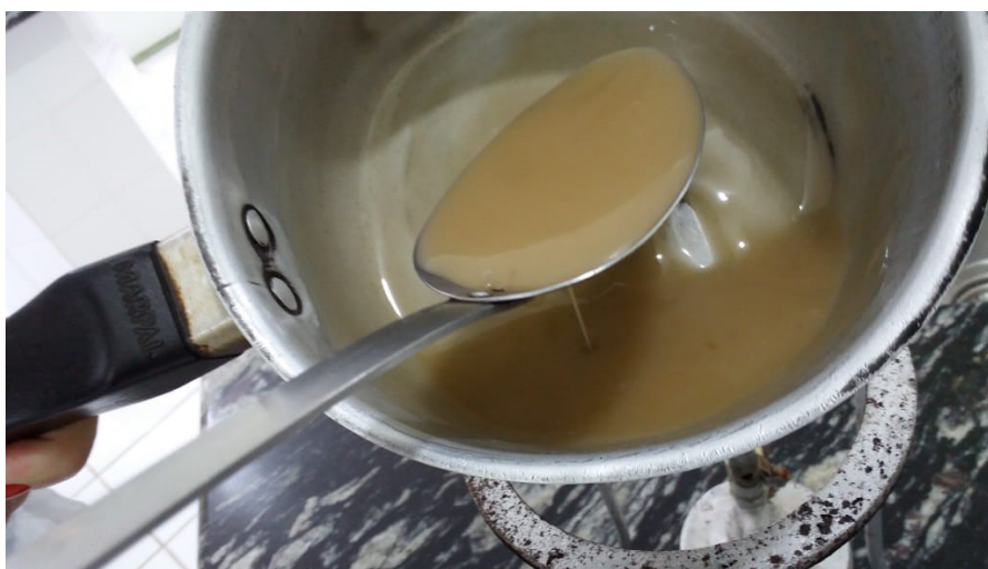
figura 1. SOLUÇÃO FIRMOGÊNICA PARA FORMAÇÃO DO BIOFILME A UMA TEMPERATURA DE 75°C.
