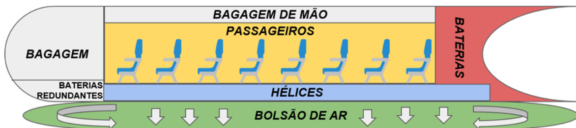
figura 3. Diagrama de possível módulo de transporte do Aurora.
