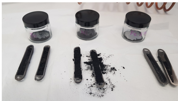
figura 5. Navículas retiradas do forno CVD após a síntese dos NTCs com os catalisadores mássicos ( \text{Fe}_2\text{O}_3 , NiO e \text{Fe}_2\text{O}_3/\text{NiO} ).
