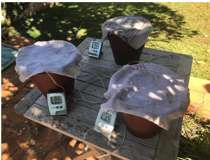
figura 1. Fotografia dos sistemas de Zeer Pot utilizados.
