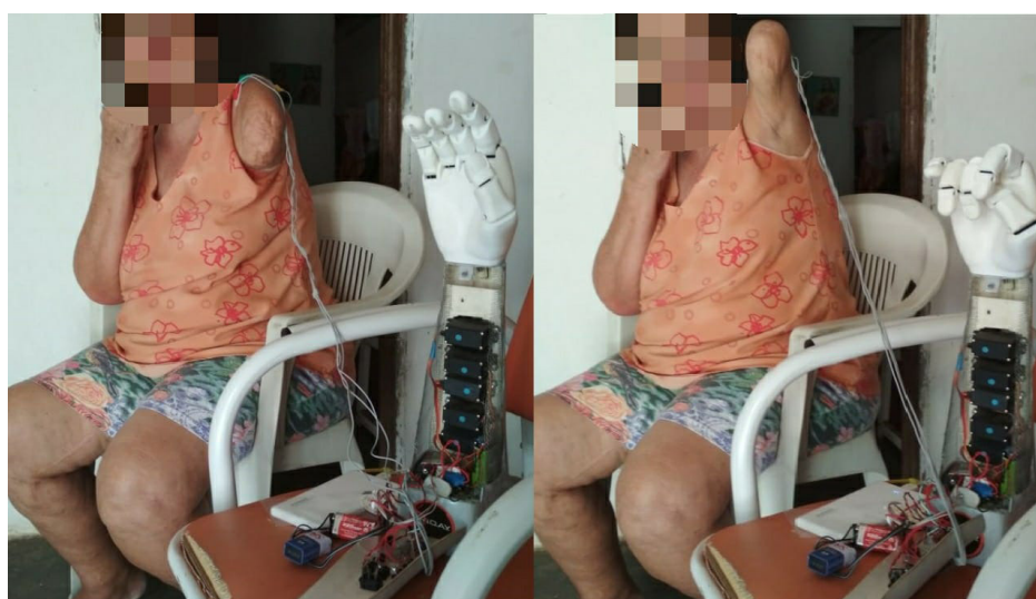
figura 10. Teste da prótese em senhora com deficiência no membro superior através do sensor muscular.
