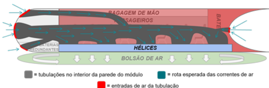
figura 6. Ilustração das entradas de ar para o sistema de levitação.
