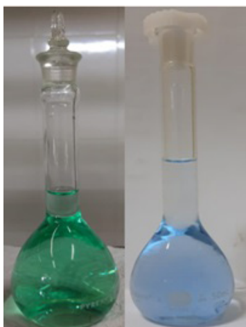
figura 9. Mudança da coloração da solução de \text{Ni}(\text{NO}_3)_2 3400 ppm para o complexo [\text{Ni}(\text{EDTA})]^{-2}
