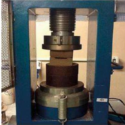
**Figura 2:** Ensaio de Resistência a Compressão.
