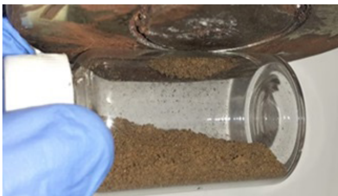
figura 7. Micropartículas de quitosana- magnetita submetidas a um ímã.
