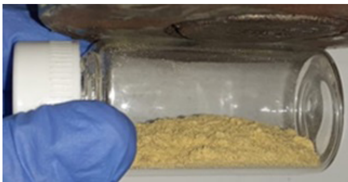
figura 8. Micropartículas de quitosana submetidas a um ímã.
